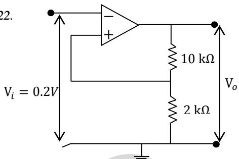
பொய்ப்பு அழுத்தம்  $0.2\text{V}$  செயற்பாட்டு விரியலாக்கிக்கு பிரயோகிக்கப்படுகிறது. பயப்பு வோல்ட்றளவு  $V_o$ .
